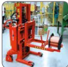
Logiflex mit seitlich verschiebbarem Träger und längs verschiebbarem Schlitzen zur Spulenübergabe.
