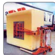
Logiflex mit Breitspurfahrwerk und Greifarmen für Schaumstoffblöcke.
