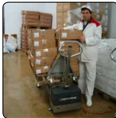
Ein elektrischer Scherenhubwagen aus Edelstahl sichert eine ergonomisch korrekte Arbeitshöhe in speziellen Umgebungen zu.
