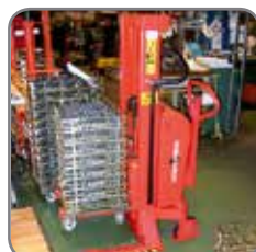
Logiflex mit Breitspurfahrwerk und kurzen Gabeln für das Handling von Drahtrahmen.
