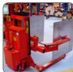
Stapler mit Breitspurfahrwerk und Greifarmen für großvolumige, leichte Güter.
