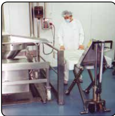
Optimale Arbeitshöhe mit dem Edelstahl-Scherenhubwagen
