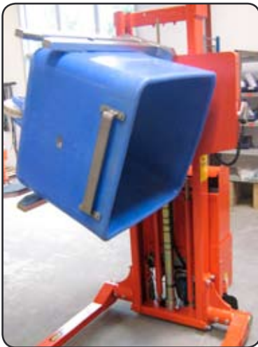
SELS mit Rotator für das Handling von Vemag-Behältern. Der Stapler wird in einer Marzipan-Fabrik in Dänemark eingesetzt. P06692
