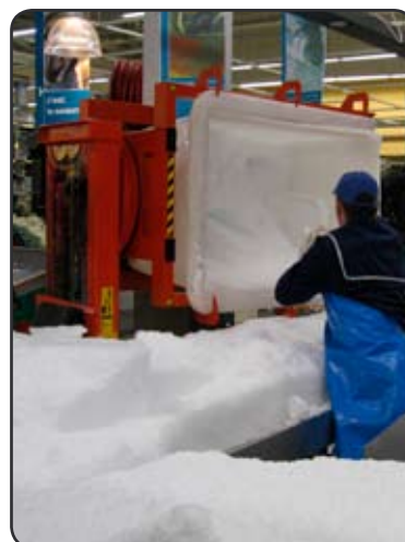
Ein SELF mit Rotator wird in einem Supermarkt eingesetzt, um Eis in die Fisch-Abteilung zu transportieren. P05707-2
