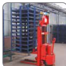
Elektro-Logiflex als fahrerloses Transportsystem - von einem zentralem PC gesteuert.
