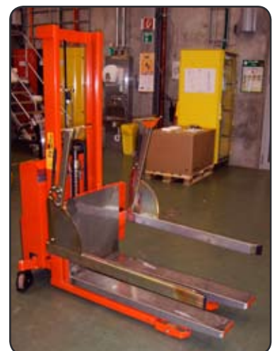
Logiflex mit Rotator in Edelstahl-Verkleidung um bei Aufnahme von Edelstahl-Behältern diese nicht zu beschädigen oder mit Farbe zu verschmutzen.
